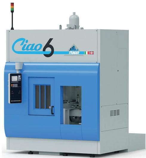
1 Neu entwickelte Vertikaldrehmaschine ›Ciao 6‹ von Famar für die Bearbeitung von Werkstücken bis 260 mm Durchmesser © Famar
